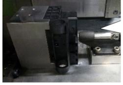
軽量化の為 軽くて丈夫な樹脂を素材として選定したが、後加工で穴の精度と同軸度を確保したいが、切削性が悪いのと、薄肉の為 加工によるビビりと割れが発生するので これを解決する方法を検討
